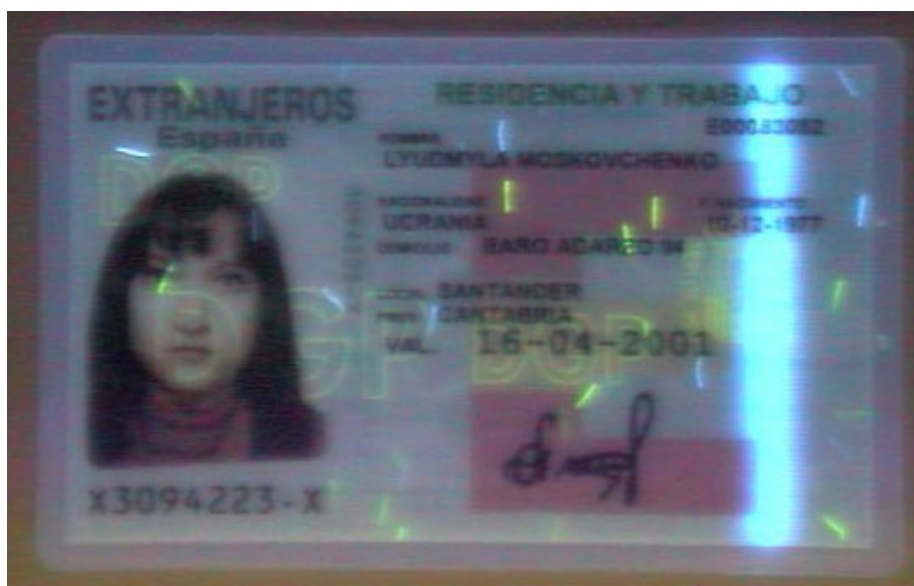
Imagen donde se observan las fibrillas luminiscentes sobre el anverso de un Permiso de Residencia y Trabajo para extranjeros.
