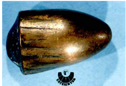
MARCAS PRODUCIDAS POR DIFERENTES MECANISMOS INTERIORES DEL ARMA.
