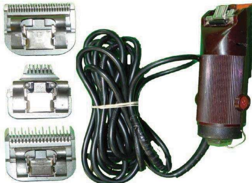
Maquinilla de esquilar con distintos modelos de cuchillas
