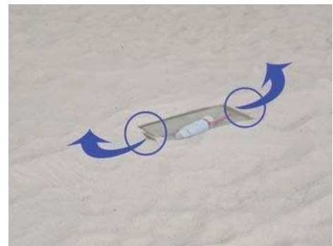
Cinta cubierta y cristal parcialmente tapado con extremos al descubierto para permitir la salida del rodillo
