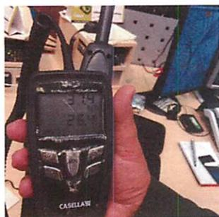
Dado que en la sala coincidió que se encontraba personal de mantenimiento con una plataforma elevadora se realizan medición de velocidad de aire justo a la salida de los difusores obteniéndose la cifra siguiente: 1,02m/s.
