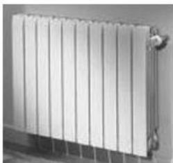
Los sistemas de calefacción utilizan en general los típicos radiadores para calentar los locales. Los hay de chapa de acero y de aluminio, y pueden ser modulares para adaptarse a la demanda del local. Disponen de una válvula manual o automática que permite el paso del agua al radiador. En este último caso el paso del agua se controla «termostáticamente» en función de la temperatura. Se suelen situar adosados en paredes junto a la ventana.
