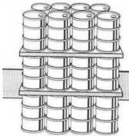
Los tambores se deben apilar de pie, con el tapón hacia arriba. Antes de comenzar la segunda fila se debe colocar tablas de madera para que sirvan de protección y soporte. Esto se debe repetir en cada una de las filas.
